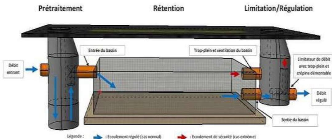
Par « équipements nécessaires à la rétention » il est entendu les équipements complémentaires, à savoir le bassin de rétention et la chambre aval de limitation/régulation (selon illustration ci-dessus). La chambre de prétraitement en amont (regard de visite, dépotoir et coude plongeur) ne fait pas partie des équipements subventionnés.
